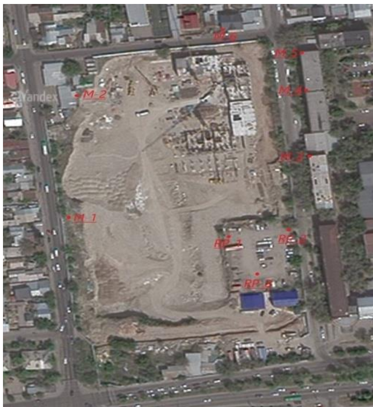
4 Сурет – Реперлер мен маркалардың құрылыс нысанында орналасуы
