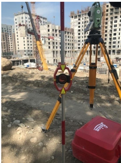
13 Сурет – Тахеометр Leica TS07 аспабы
